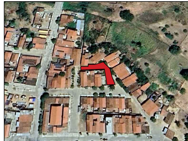
ÁREA TOTAL: 408m 2 de Pavimentação Meio Fio: 260m linear
