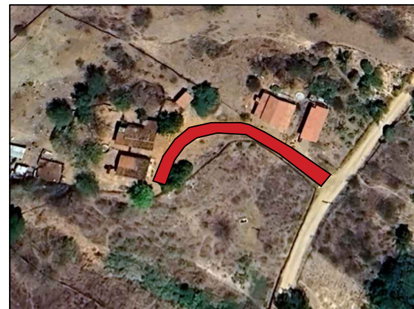
ÁREA TOTAL: 400m 2 de Pavimentação Meio Fio: 160m linear
